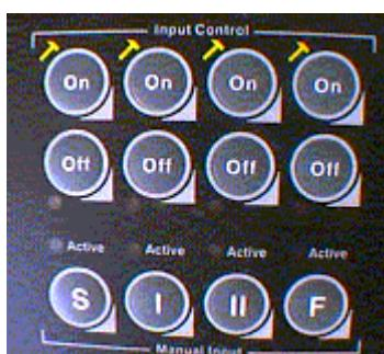
Nella zona a sinistra, sotto la stampante sono posizionati i dodici tasti per il controllo delle quattro linee di ingresso (On, Off, Manual). Pur essendo a membrana, la tastiera permette una digitazione abbastanza veloce e precisa, non richiede elevate pressioni con le dita ed ha caratteristiche ergonomiche vicine a quelle delle tastiere tradizionali.
