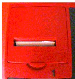
La stampante, che utilizza carta termica, è alloggiata in un apposito vano nella parte sinistra dell'apparecchio. Nello stesso vano è contenuto anche il rotolo della carta largo 58mm, con 35mt di lunghezza. La velocità di stampa è superiore alle 6 linee al secondo e la leggibilità è ottima.
