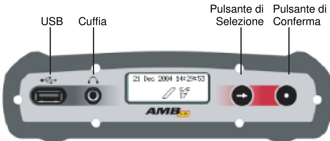
**Figura 1.4: Decoder con il display di stato**
