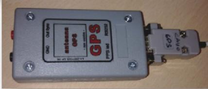
Il **ricevitore GPS**, fornito come accessorio ed alimentato direttamente dal tabellone, è in grado di sincronizzare, tramite la rete satellitare, l'orologio interno del display.
