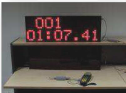
Esempio di un utilizzo standard, collegando un singolo display al Timy Alge. Vengono visualizzati pettorale, tempo gara e posizione provvisoria in classifica.
