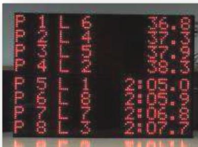
Qui di fianco, ad esempio, la visualizzazione dei risultati di una gara di nuoto con 8 corsie cronometrate. Con soli 2 display si è in grado di visualizzare la corsia (L), il tempo e la posizione in classifica (P) della batteria di tutte le corsie; altezza carattere 70mm (*protocollo Microgate-Microtab*)
